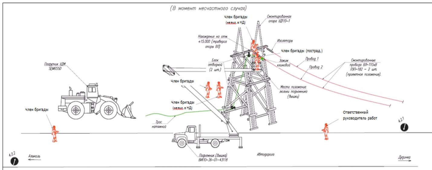
Производитель работ и электромонтёры-линейщики с люльки автогидроподъёмника произвели разрезку трёх проводов ВЛ-110 кВ ЛЭП-182 в пролёте опор № 199-200 на расстоянии 100 метров от опоры № 199. Далее был проведён монтаж проводов ВЛ-110 кВ ЛЭП-182 со стороны опоры № 200 на деревянную опору УД-110-1. Трое членов бригады соединяли и удлиняли провода, отходящие от опоры № 199 и лежащие на земле. После был выполнен монтаж первого провода (фаза 1) на деревянную опору УД-110-1.
